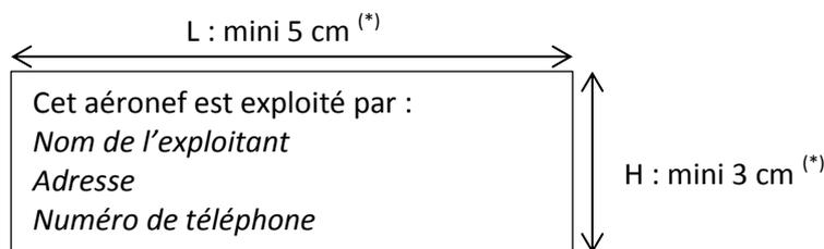
(\*) ou étiquette de surface équivalente si la géométrie de l'aéronef le nécessite ( $L \times H \geq 15 \text{ cm}^2$ )
